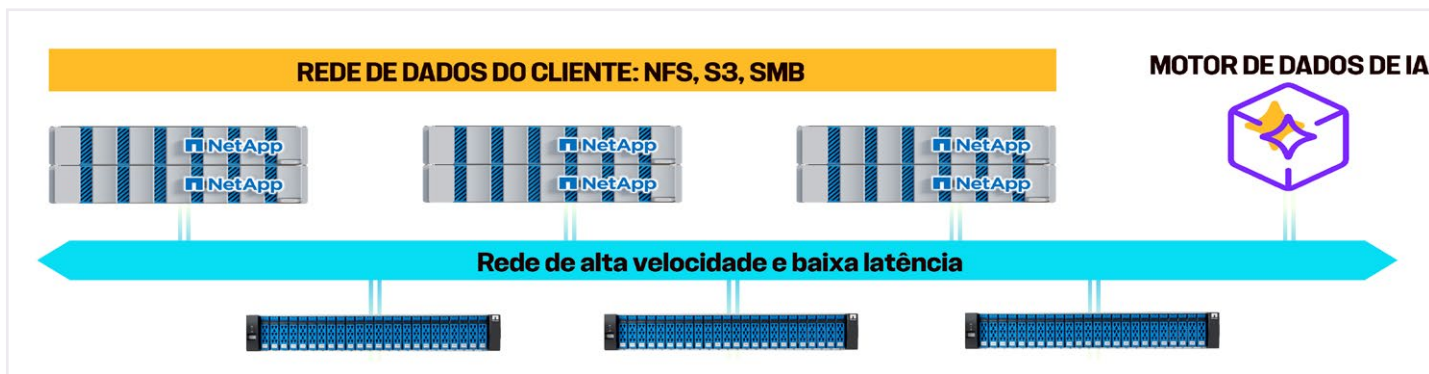
Figura 1: NetApp A implementação do AFX consiste em controladores de storage AFX 1K e gabinetes de storage NVMe NX224.
