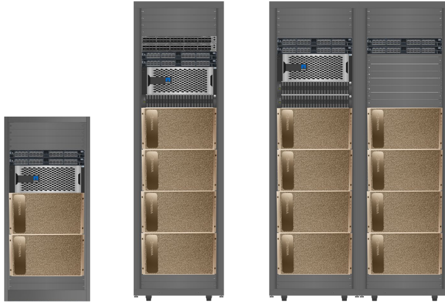
그림 1) DGX A100, 2, 4, 8 노드 구성의 ONTAP AI 아키텍처
