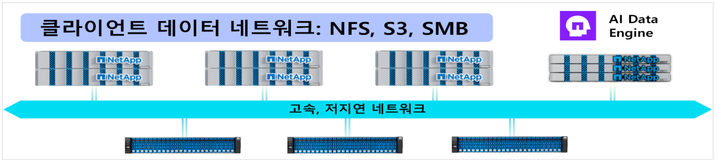
그림 1: NetApp AFX 배포는 AFX 1K 스토리지 컨트롤러, NX224 NVMe 스토리지 인클로저, 선택적 DX50 데이터 컴퓨팅 노드로 구성됩니다.
