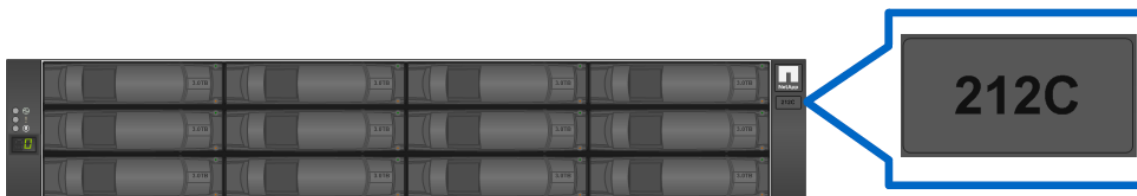
図 62) DE212C の前面図とエンドキャップ
