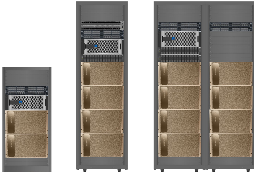
Figura 1) Arquitecturas de ONTAP AI con DGX A100; configuraciones de dos, cuatro y ocho nodos.
