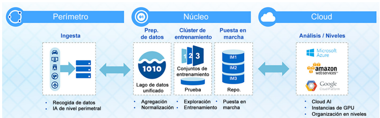
Figura 2: Canalización de datos del perímetro al núcleo y al cloud.
