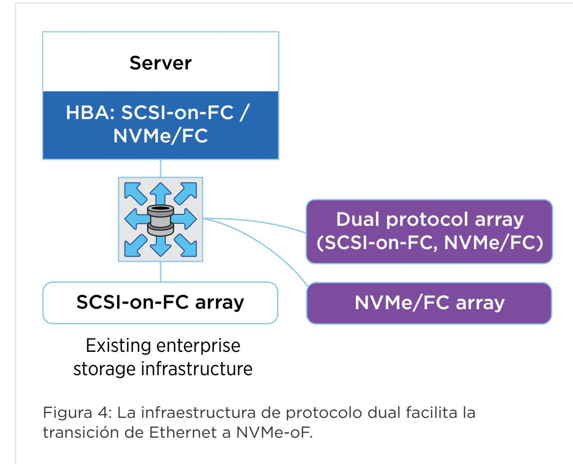
Figura 4: La infraestructura de protocolo dual facilita la transición de Ethernet a NVMe-oF.
