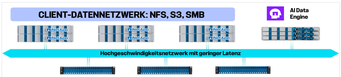
Abb. 1: Die NetApp AFX-Bereitstellung besteht aus AFX 1K-Speichercontrollern, NX224 NVMe-Speichergehäusen und optionalen DX50-Datenrechenknoten.
